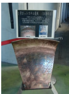
ポットスチルの底板(銅製)
